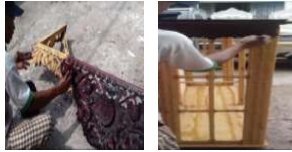
Gambar 5. Pengecatan dasar pada seluruh bagian lemari
