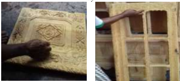
Gambar 4. Pengeleman/pendempulan pada seluruh bagian lemari
