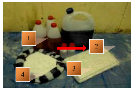
Gambar 3. Bahan fiberglass, 1) Resin, 2) Catalis 3) Serbuk kaca (meed), 4) Tepung tulang.
