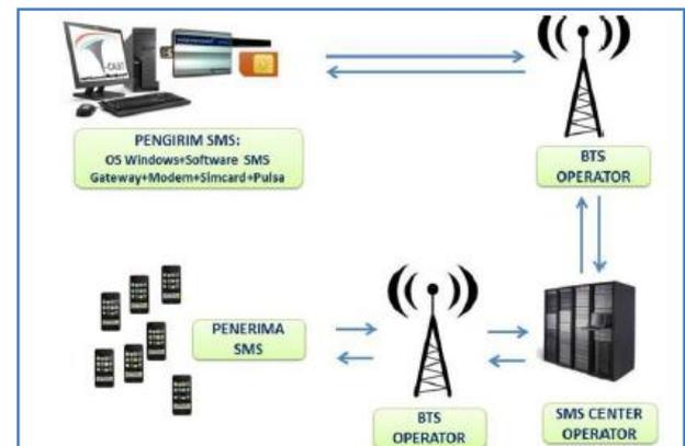
Gambar 1. Ilustrasi konsep SMS gateway [5]
