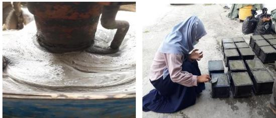
Gambar 2. Pengadukan dan pencetakan benda uji
