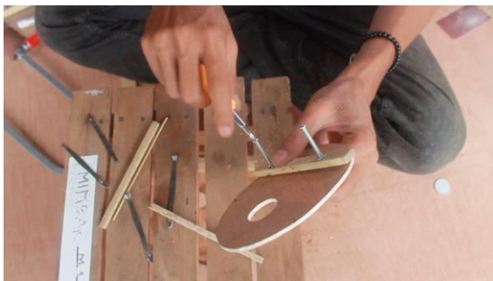
Gambar 12: Posisi baut pada kayu dan triplek
