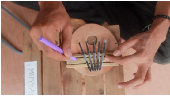
Gambar 11: Posisi kayu dan pinset serta pemberian tanda pada kayu
