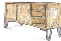
Gambar 11. Sketsa Alternatif konstruksi kaki Furniture
