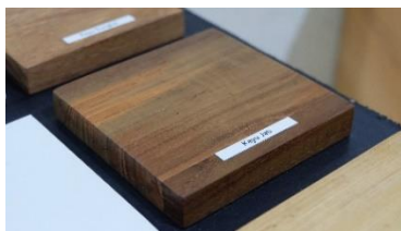
Gambar 7. Material Board Kayu Jati dengan Finishing Natural
