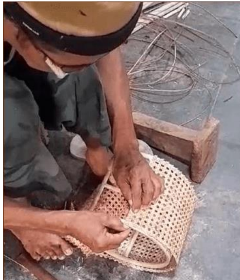
Gambar 5. Pengayaman Pada Kap Lampu (Sumber Foto : Kelompok Table Lamp , 2024)
