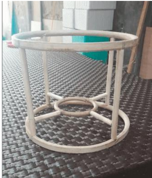
Gambar 7 Rangka Kap Lampu (Sumber Foto : Kelompok Table Lamp , 2024)
