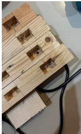
Gambar 17 Pembuatan sambungan mortise and tenon Sumber: Nadia, 2026
