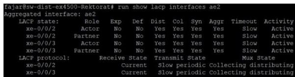
Gambar 5. Status LAG ae2 pada switch distribution
