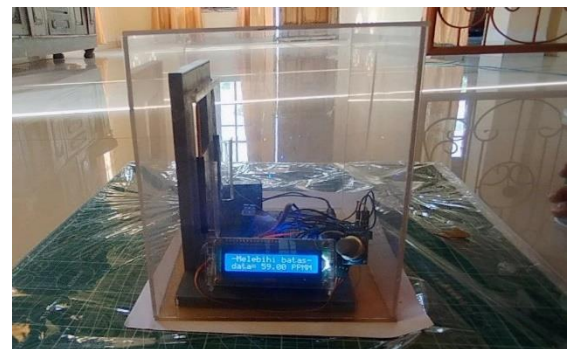
Gambar 4. 4 Pengujian Notifikasi Buzzer
