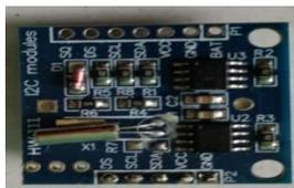
Gambar 2.10 *RTC (Real Time Clock) DS1307*
