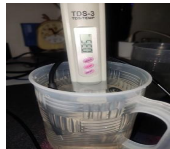
Gambar 10 Pengujian Alat TDS air jernih
