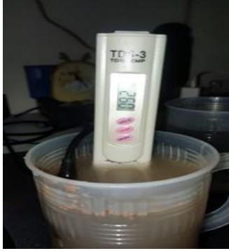
Gambar 11 Pengujian Alat TDS air keruh
