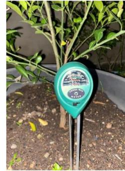
**Gambar 17** Pengujian pH Tanah.
