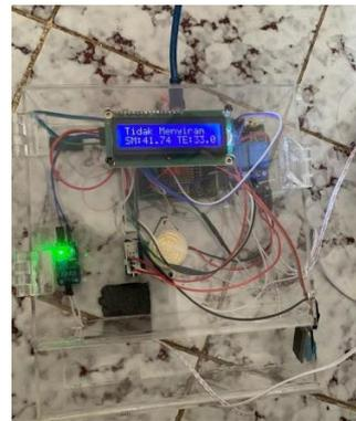
**Gambar 13** Hasil Perancangan Alat Kelembapan Tanah Dan Suhu.
