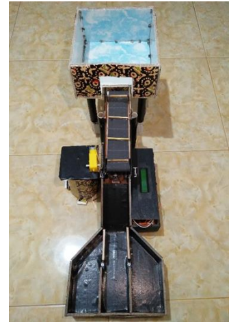
Gambar 15 Keseluruhan Alat Sistem Pendeteksi Kualitas Telur
