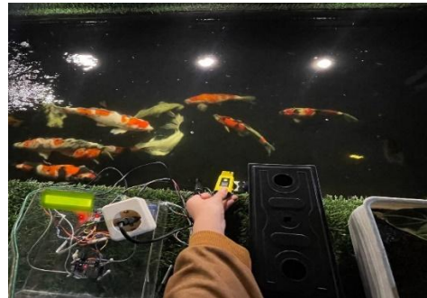
Gambar 2 Pengujian Sensor pH Air.
