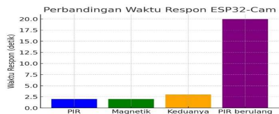
Gambar 4.7 Diagram Batang Waktu Respon ESP32-Cam
