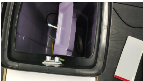
Gambar 7. Servo bergerak 180° ke wadah non-logam.
