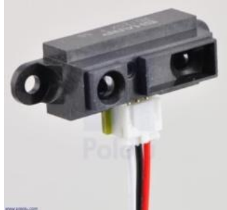
Gambar 2. IR SHARP GP2Y0A21 [6]
