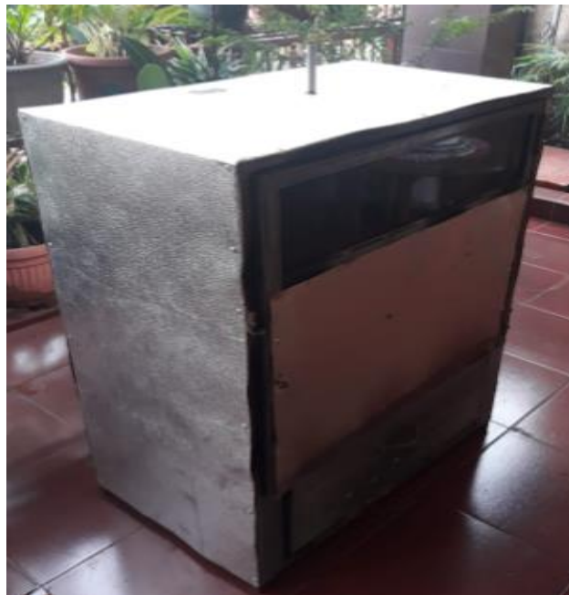
Gambar 7. Peralatan pengasap ikan sederhana tipe kabinet
