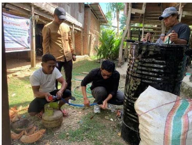
**Gambar 4.** Pembuatan arang dan asap cair dengan pembakaran reaktor pirolisis
