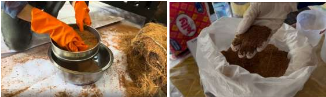
Gambar 4. Pengolahan Limbah Sabut Kelapa Menjadi Cocopeat
