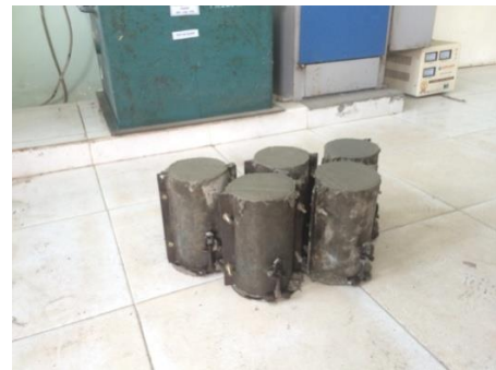
Gambar. 3. Proses pencetakan benda uji
