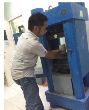
Gambar. 4. Pengujian kuat tekan beton busa
