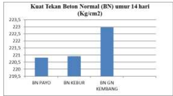
Gambar 7. Grafik hasil kuat tekan beton normal K-250 untuk umur 14 hari
