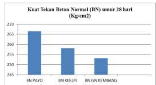
Gambar 8. Grafik hasil kuat tekan beton normal K-250 untuk umur 28 hari
