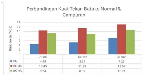
**Gambar 3.** Hasil Pengujian Kuat Tekan Beton
