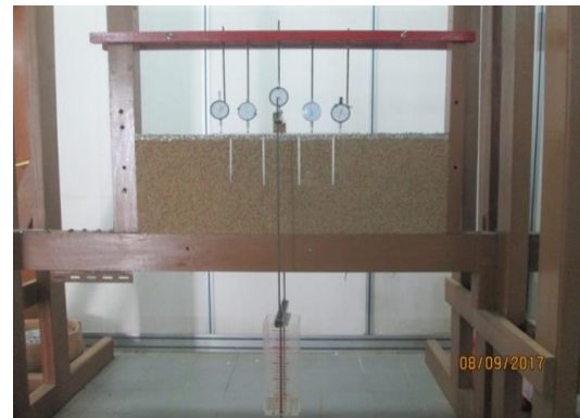
Gambar 3. Pengujian 2 dimensi model Sitem Pelat terpaku pada kondisi tanah datar
