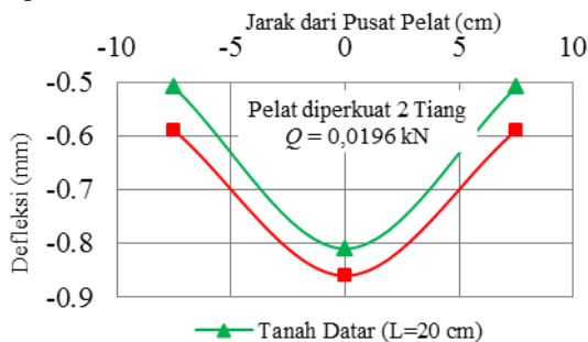
Gambar 7. Hasil uji beban sentris pelat diperkuat 2 tiang pada tanah datar dan tanah timbunan.
