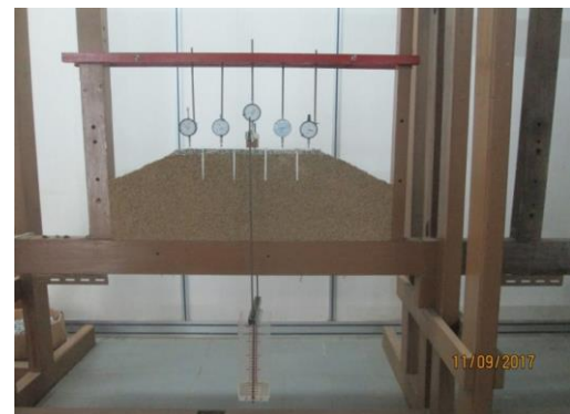
Gambar 4. Pengujian 2 dimensi model Sitem Pelat terpaku pada kondisi timbunan
